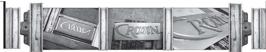
→ elementos básicos para producir el timbrado: cuños macho y hembra que lograrán la operación complementaria
